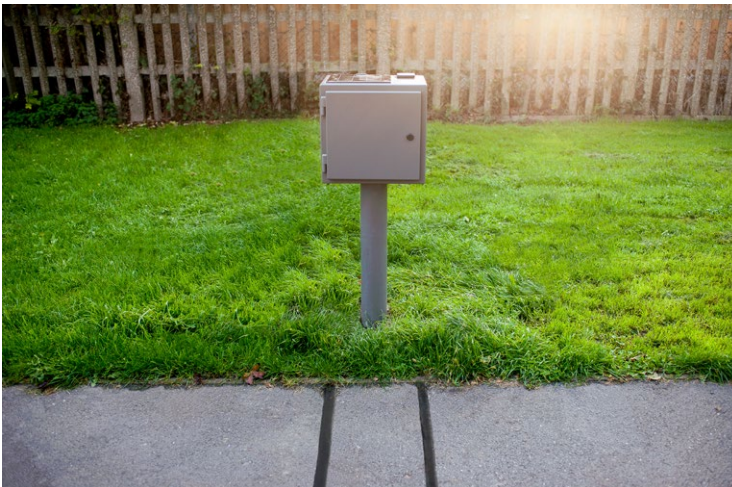
Sistema RidePod™ BP instalado de manera permanente para el monitoreo de bicicletas sobre una ruta compartida.
